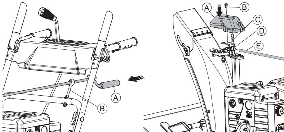
Проденьте рукоятку поворота желоба (A) через хомут (B) нижней рукоятки и установите её в отверстие рулевого механизма, зафиксируйте штифтом. Установите декоративную крышку (A) и зафиксируйте её. Используйте крепеж из бокса №10: (B) болт М6×12 – 1 шт.; (C) шплинт – 1 шт.
