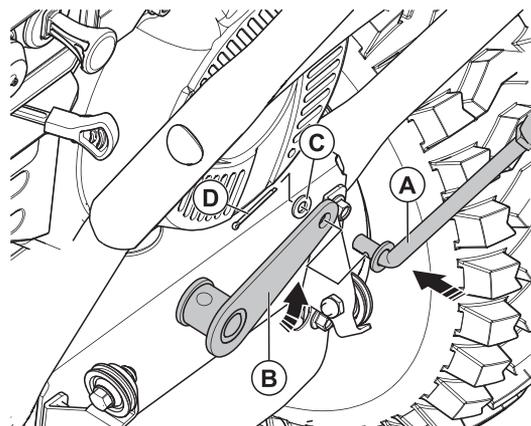
Установите на снегоуборочной машине в отверстие коннектора (B) тягу (A) и закрепите, используйте крепёжные элементы - №12: (C) шайба - 1 шт.; (D) шплинт - 1 шт.
