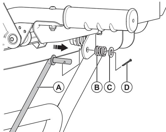
Установите на верхней рукоятке в приемное отверстие рычага переключения передач тягу (A), используйте крепёжные - бокс №11: (B) пружина - 1 шт.; (C) стопорное кольцо - 1 шт.; (D) шплинт - 1 шт.
