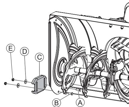
Для предохранения от повреждений частей ковша снегоуборочной машины установите башмаки по его обеим сторонам. Используйте детали крепежа из бокса №16: (A) болт М8×25 – 2 шт.; (B) болт М8×20 – 2 шт.; (D) гроверная шайба D8 – 4 шт.; (E) Гайка М8 – 4 шт.
