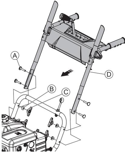
Совместите отверстия нижней и верхней рукояток, и закрепите при помощи болтов и пластиковых барашковых гаек. Используйте крепёжные элементы - бокс №3: (А) болт М8х50 – 4шт.; (В) фигурная шайба – 4 шт.; (С) барашковая гайка М8 - 3 шт. Затяните болты от руки. Закрепите трос привода шнеков.
