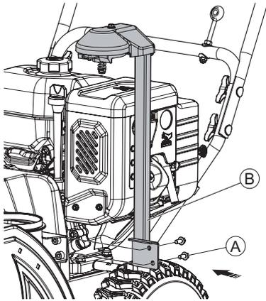
Установите поворотный механизм (B) на кронштейн снегоуборщика и закрепите при помощи болтов (A). Используйте крепёжные элементы из бокса №6: (A) болт M8x16 – 2шт
