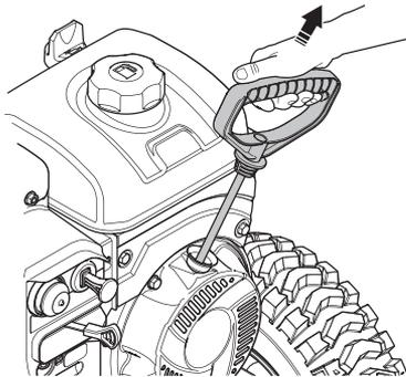
**Примечание!** Не рекомендуется вытягивать шнур стартера максимально (*на всю длину*), а также резко не отпускайте его при повторной попытке завести двигатель, удерживая ручку, плавно верните его в исходное положение.
